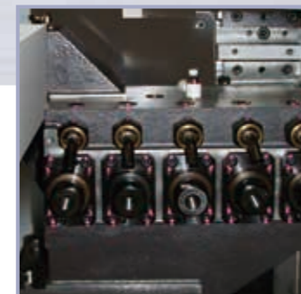
Rückseitiger Antrieb (rückseitiger Werkzeughalter) Basisvorrichtung zur Montage von angetriebenen Werkzeugen am rückseitigen Werkzeughalter.
