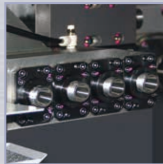
Rückseitiger Antrieb (rückseitiger Werkzeughalter) Basisvorrichtung zur Montage von angetriebenen Werkzeugen am rückseitigen Werkzeughalter. (Option bei Maschinen des Typs B0265E/265BE/325E/325BE-II)
