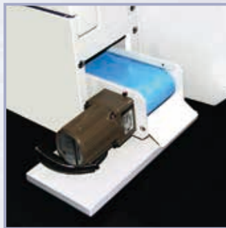
Werkstücktransporteinrichtung Nachdem das von der Gegenspindel ausgeworfene Werkstück von einem Teilefänger aufgenommen wurde, wird es mit einem Werkstückförderer aus der Maschine herausbefördert.
