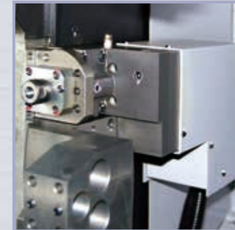
Hinterer Antrieb (hinterer Werkzeughalter) Basisvorrichtung zur Montage von angetriebenen Werkzeugen am hinteren Werkzeughalter.
