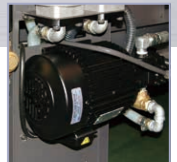
Hochdruckpumpe (1500 W) Wenn die optionalen Funktionen "Hochdruck-Ölzufuhr über M-Code" und "Werkstückfrontladergerät" aktiviert sind, dieses Pumpensystem verwenden.
