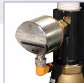
Kühlmittelschalter Wenn die Durchflussmenge des Kühlmittels abnimmt, wird die Maschine gestoppt. Dies verringert die Gefahr von mangelhafter Bearbeitung und Bränden aufgrund von fehlendem Kühlmittel.
