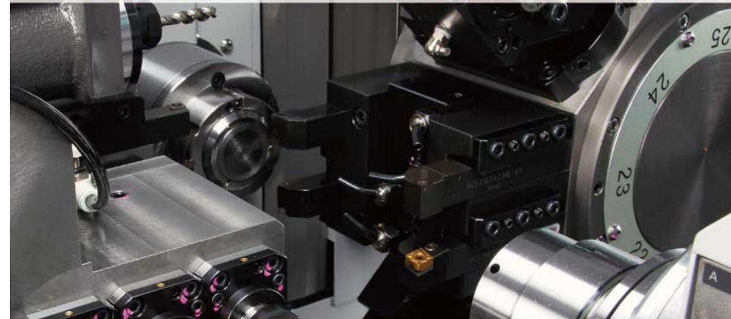
Langdrehautomat mit Revolver + gekoppeltem Werkzeughalter + rückseitigem Werkzeughalter und drei Y-Achsen für die Komplettbearbeitung
